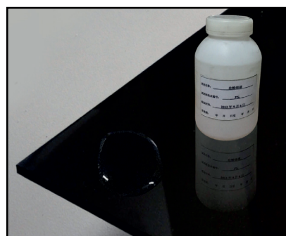
ТЕСТ СОЛЯНОЙ КИСЛОТОЙ - ДРУГАЯ ТОРГОВАЯ МАРКА
